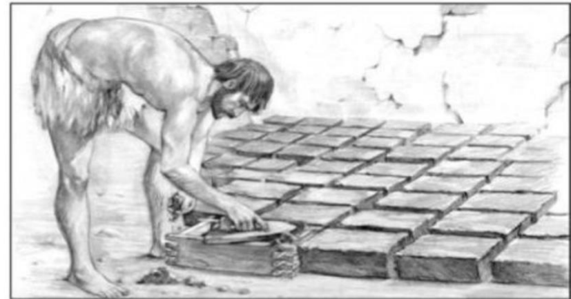
Fig. 3. (à gauche) Évolution de la brique en Mésopotamie : A) modelée (8 e millénaire), B) semi-moulée (7 e millénaire), C) moulée (6 e millénaire). (en haut à droite) Ouvrier tassant de la terre à bâtir à l'intérieur d'un moule. (en bas à droite) Ouvrier raclant la surface du cadre avant de démouler.
